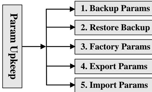
Fig. 7-9 Submenu list of parameter upkeep
